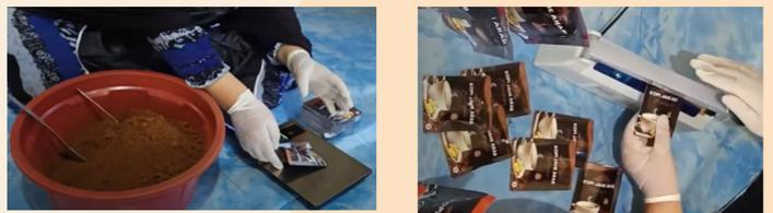
alat penunjang produksi yang diserahkan antara lain timbangan digital, tempat khusus penyimpanan serbuk kopi, vakum sealer untuk kemasan sachet dan mesin grinder kopi.
